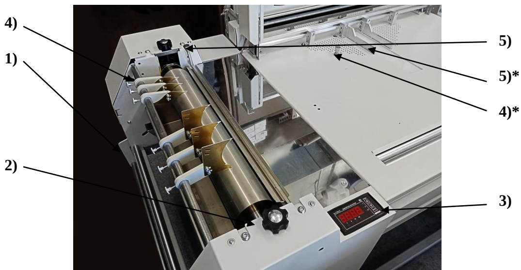
Рис. 3. Клеемазальное устройство (вид сверху)
